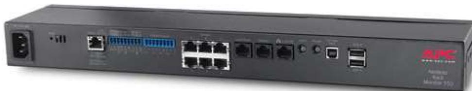
Если необходимо контролироваться крупный центр обработки данных или большое количество параметров, здесь уже не обойтись без стоечной модели с возможностью подключения до 78 датчиков.
