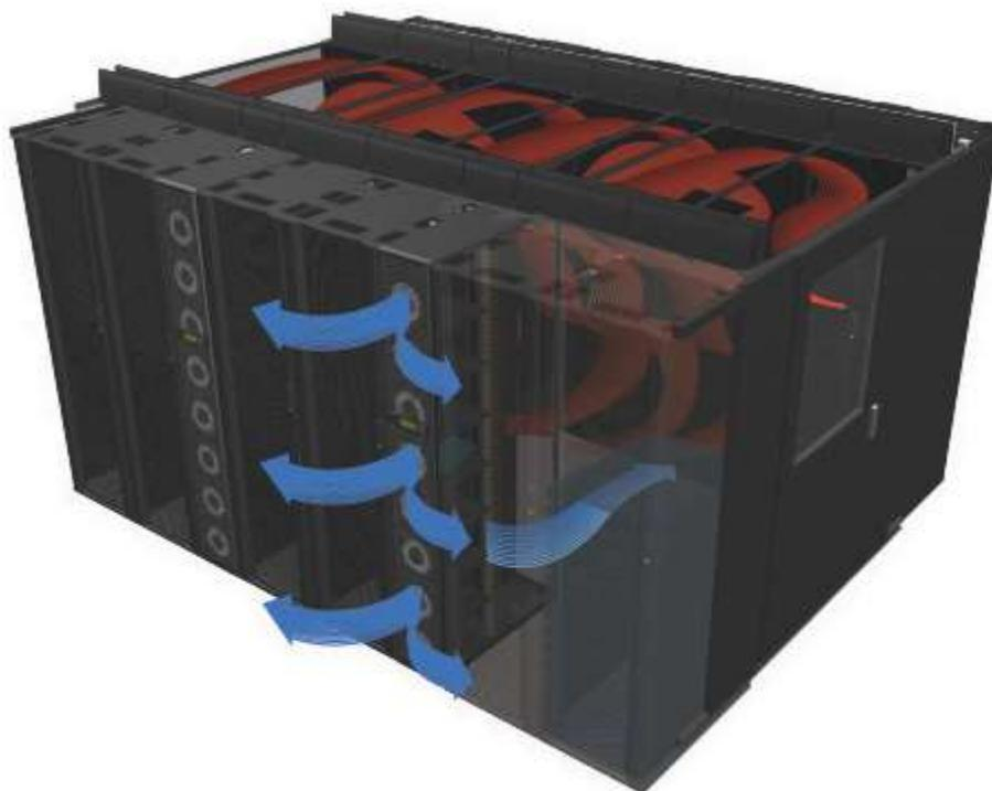
«Горячий» коридор между стойками изолируется от внешней среды. Внутривырядные кондиционеры забирают воздух из этого коридора, охлаждают его и выбрасывают охлажденный воздух в помещение. При необходимости, аналогичную систему можно сделать для одной стойки, и выглядеть это будет вот так:
