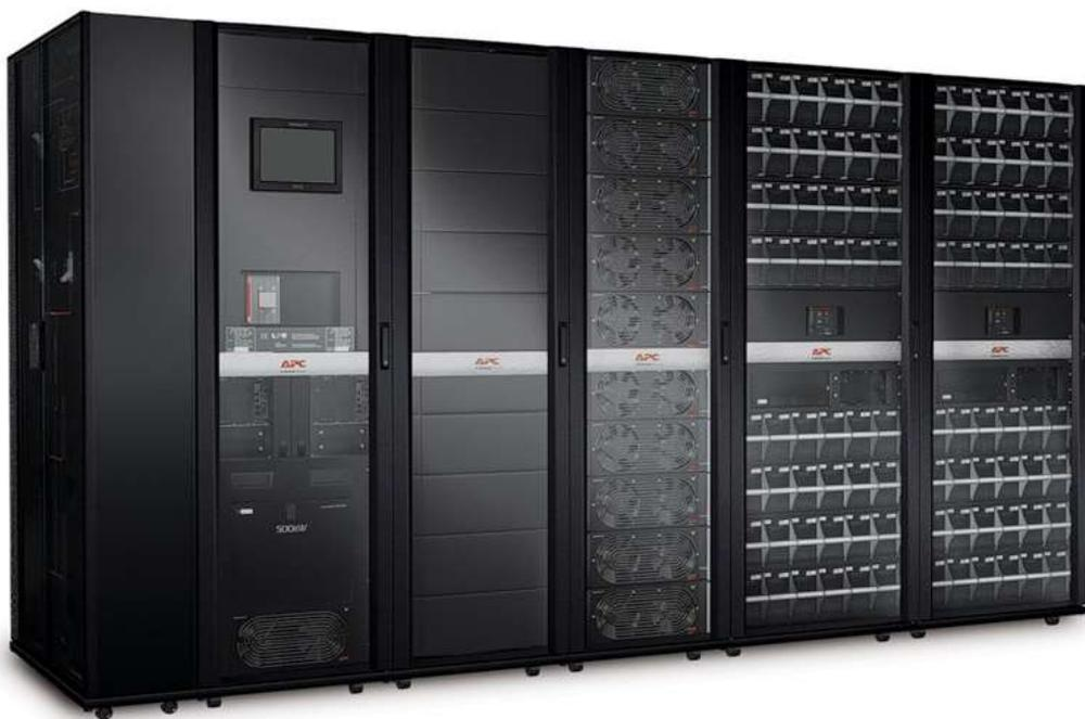
А вот и наш главный герой: трехфазный ИБП APC Symmetra PX мощностью 250 киловатт, расширяемых до 500 при необходимости. Как и многие другие разработки APC для ЦОДов, это полностью модульная система, в которой предусмотрено резервирование абсолютно всех компонентов: блоков управления, силовых модулей, батарей и прочего. Крайние стойки на фото полностью заполнены аккумуляторами, вот такими:
