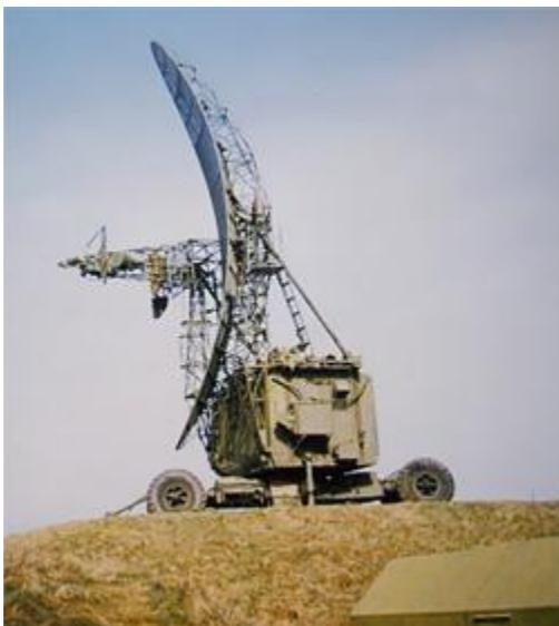
Комплекс РЭБ Наземный комплекс мощных помех "Пелена-1". Предназначен для подавления РЛС самолетов ДРЛО.
