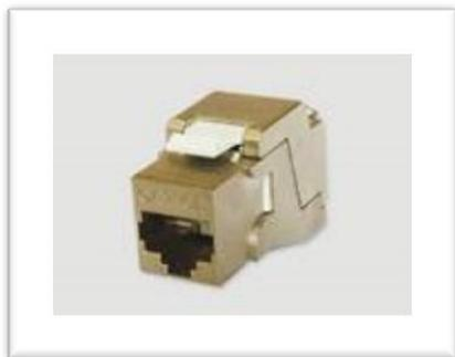
Модуль FTP Keystone представляет собой экранированное 8-позиционное решение с разъемом RJ-45. Модули Eurolan FTP позволяют избежать использования ударного обжимного инструмента благодаря технологии контактов IDC. Компонент защищен никелевым покрытием.
